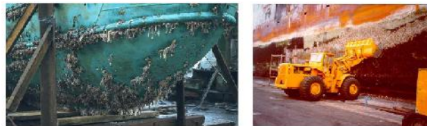
شکل (۱) رسوب دریایی تشکیل شده بر روی بدنه شناورها [6].
